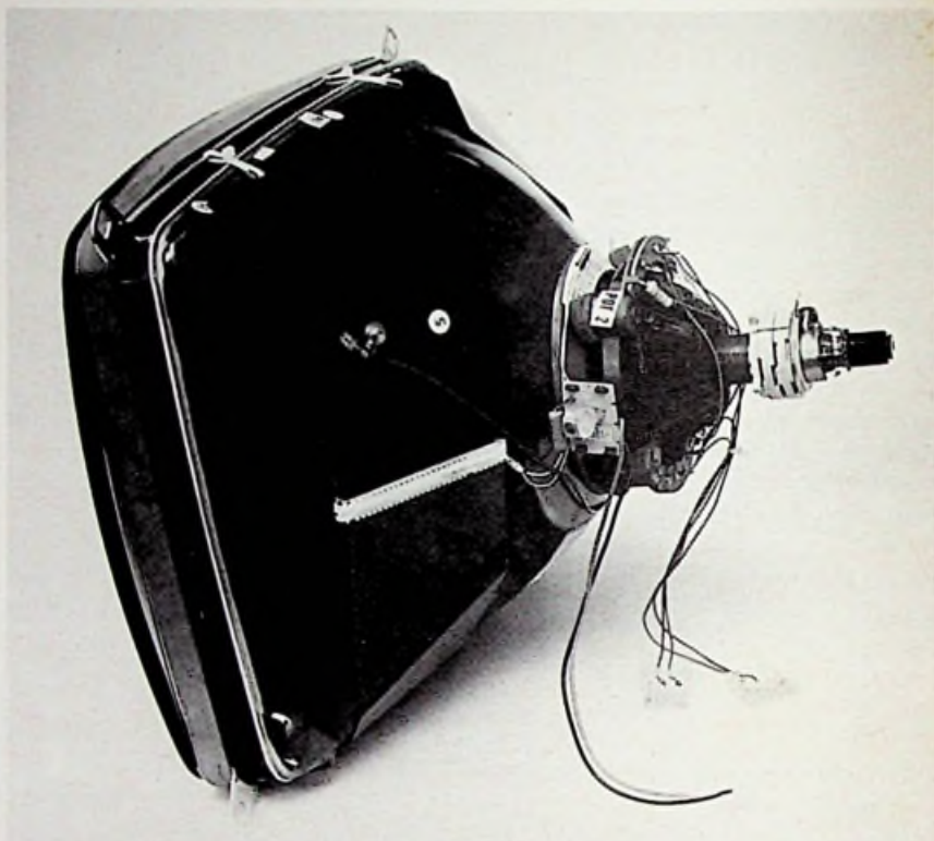
Precision-In-Line beeldbuis, compleet met aangekitte afbuigspoel en automatische d magnetisatie.
